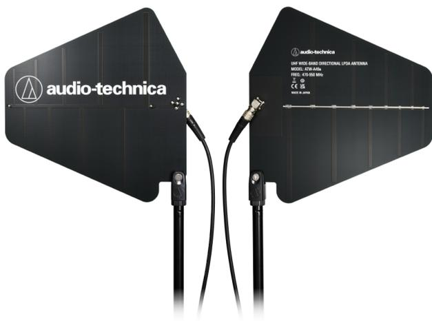
ATW-A49a 是两个一组装的 UHF 宽带定向型 LPDA (对数周期偶极阵列) 天线, 在整个宽带范围 (470~950 MHz) 内为 UHF 无线系统提供增强的信号接收。每个天线板匹配 50 欧姆阻抗, 整合了的高质量低损耗的 BNC 连接器, 具有 6dBi 增益。配有 5/8"-27 螺纹支架接头, 可作永久或临时安装。
